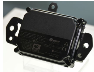
プリウス用ミリ波レーダー 横方向長さ 100 mm程度
